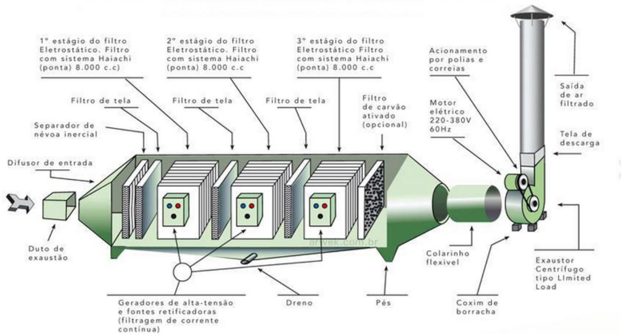
O Filtro Eletrostático funciona através da atração de partículas carregadas eletricamente por uma fonte de alta tensão, que são ionizadas e captadas por placas coletoras. O fluxo de ar é passado por uma alta diferença de potencial, ionizando as partículas que são polarizadas e atraídas pelas placas coletoras. As partículas retidas nas placas coletoras são então eliminadas do ar, dependendo do poluente.
